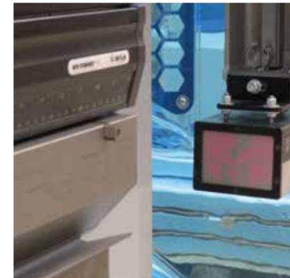
El sistema "RapidBend ultimate" elimina la velocidad lenta por completo. Las herramientas van a la máxima velocidad hasta que el punzón llega a la superficie del material. La tecnología "RapidBend" puede reducir el tiempo de ciclo de la máquina en más de dos segundos por ciclo. Esto representa un ahorro significativo en el tiempo de funcionamiento y coste.
