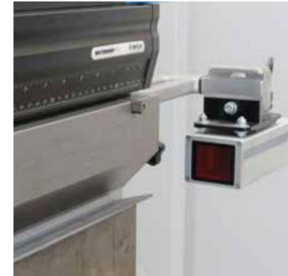
Permite al operario trabajar con seguridad cerca de los útiles, incluso cuando la trancha y los topes se mueven a alta velocidad. La velocidad máxima se puede mantener hasta 6 mm de distancia de la pieza. El sistema supervisa continuamente el rendimiento de velocidad y parada del pistón de la plegadora.
