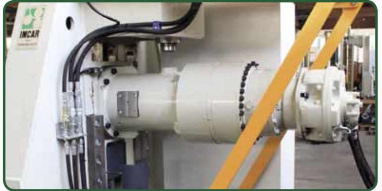
Sistema di innesto rapido per intercambiabilità del rullo superiore Système de largage rapide pour le rouleau supérieur interchangeable Sistema de desenganche rápido para el rodillo superior intercambiable Interchangeable quick-release system for the top roll Schnellwechseinrichtung für Oberwalze Система быстрой замены верхнего валька
